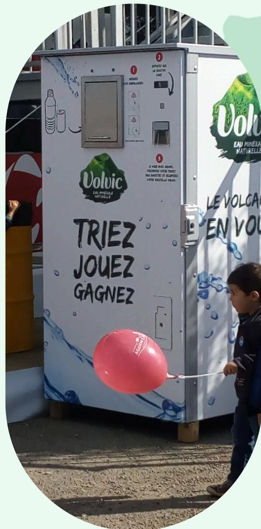
La Easy+ détecte et trie les **bouteilles PET, canettes et gobelets** avec une capacité de stockage **jusqu'à 1 500 emballages**
