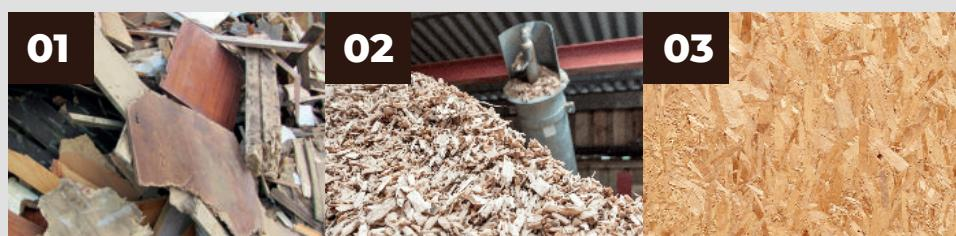
D'abord, les différentes pièces de bois à recycler sont triées, manuellement ou mécaniquement selon leur taille et leur niveau de traitement
