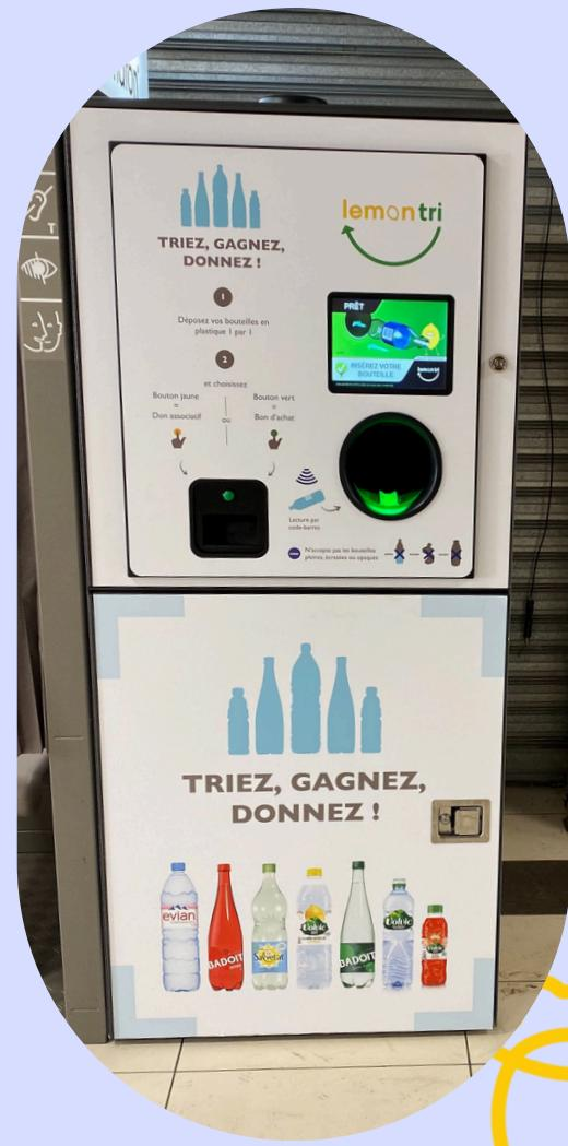
La Ultra détecte, trie et compacte les **bouteilles PET, et canettes** avec une **capacité de 300 bouteilles et 700 canettes**
